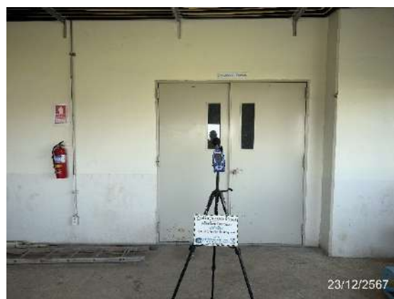
รูปที่ 3.6 | ตรวจวัดเสียง บริเวณ Shredder
